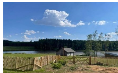
Valla empalizada – H 1,2 m Separación 3–4 cm
