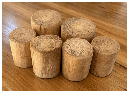
Pavimentos de acacia, lijados sin albura , diámetros similares (8 a 15cm)
