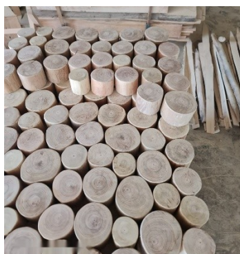
Pavés en robinier, poncés avec aubier , diamètres similaires (8 à 15cm)
