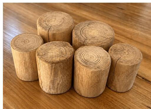
Pavés en robinier, poncés sans aubier , diamètres similaires (8 à 15cm)
