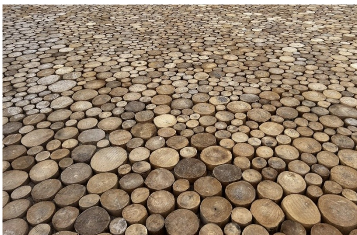
Pavés en robinier, avec aubier , diamètres variés
