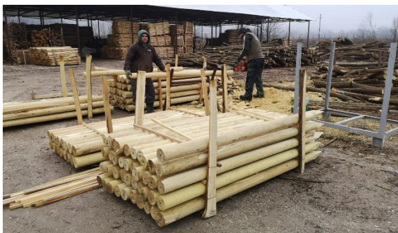
Pfähle gefräst 14 cm
