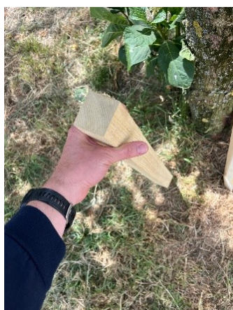
Vierkante palen, 4 zuivere zijden Afm 5 × 5 cm,
