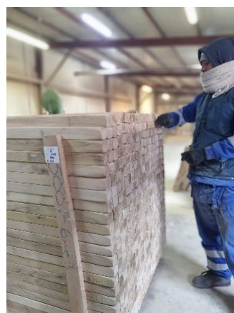
Vierkantpfähle 4 saubere Seiten, geschliffen Maß 5 × 5 cm
