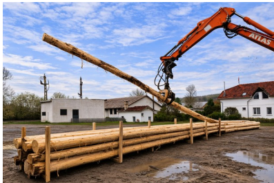
Poteaux écorcés de 12 m de long
